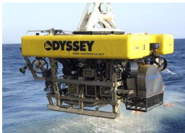
Ил. 14. «Зевс» – 7-тонный подводный телеуправляемый аппарат фирмы «Odyssey Marine Exploration».
